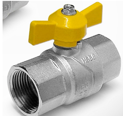
Imagem ilustrativa 04 – VÁLVULA ESFERA (REGISTRO) EM LATÃO BI-CROMATIZADO PARA GÁS, MANOBRA TIPO BORBOLETA NA COR AMARELA, EXTREMIDADES FÊMEAS, PN 20 OU SUPERIOR - DN 1/2"
